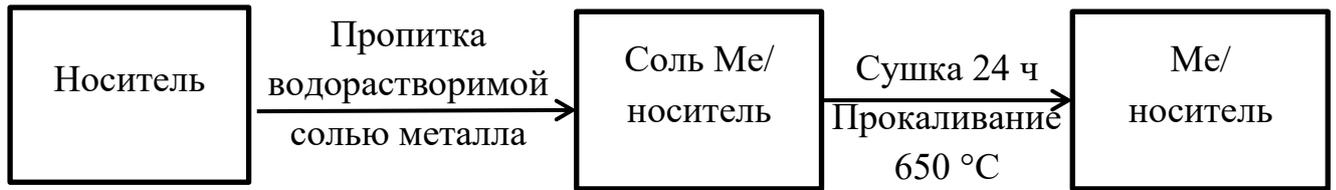
Рисунок 11 – Схема приготовления добавок на основе носителей MCM-41/ $\gamma$ - $Al_2O_3$ , HMS/ $\gamma$ - $Al_2O_3$  и  $\gamma$ - $Al_2O_3$
