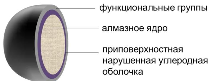
**Рисунок 1.** Модель структуры частицы наноалмаза [78, 79].
