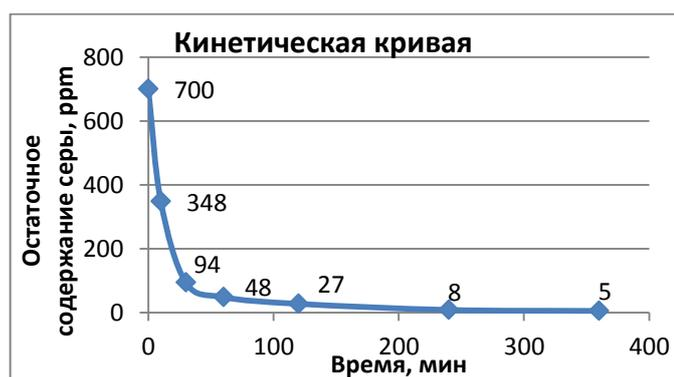
**Рисунок 6.** Влияние времени реакции окисления на глубину обессеривания прямоугольной бензиновой фракции. Условия реакции: температура 40 °С, соотношение H<sub>2</sub>O<sub>2</sub>:S:Mo:H<sub>2</sub>SO<sub>4</sub> = 400:100:1:100 по молям, исходное содержание серы – 700 ppm.
