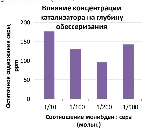
**Рисунок 4.** Влияние концентрации катализатора на глубину протекания обессеривания. Условия реакции: 2 ч, 20°C, соотношение H<sub>2</sub>O<sub>2</sub>:S = 4:1 по молям, исходное содержание серы – 700 ppm.
