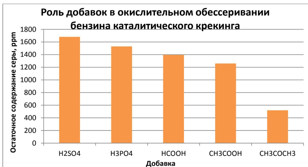
**Рисунок 10.** Зависимость остаточного содержания общей серы в бензине каталитического крекинга после окисления в присутствии различных добавок. Условия реакции (3 ч, соотношение сера : молибден : пероксид водорода : добавка = 100:1:400:100 по молям). Исходное содержание серы 2500 ppm.
