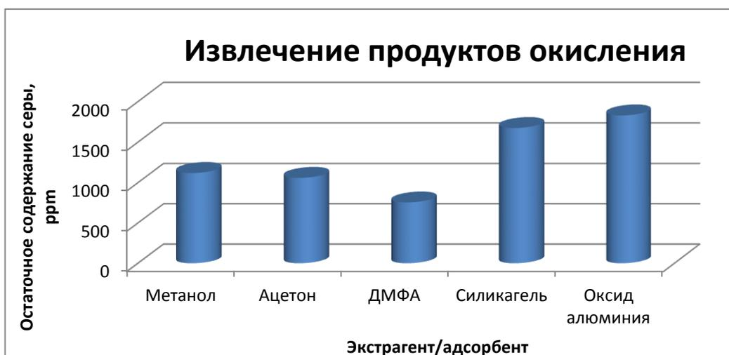
**Рисунок 11.** Зависимость содержания серы от способа извлечения продуктов окисления из бензина каталитического крекинга. Условия реакции (3 ч, соотношение сера : молибден : пероксид водорода = 100:1:400 по молям, соотношение экстрагент : топливо = 1:1 (по объему), количество адсорбента 4 г на 20 мл топлива). Исходное содержание серы 2500 ppm.
