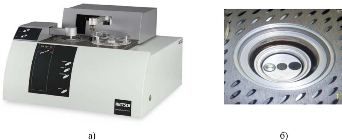
**Рисунок 3.2.** Внешний прибора ДСК (а) и ячейки (б) для измерений теплоемкости
