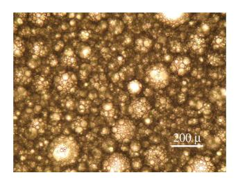
Рис. 69. Морфология эмульсии Эмицф (оптическая микроскопия).
