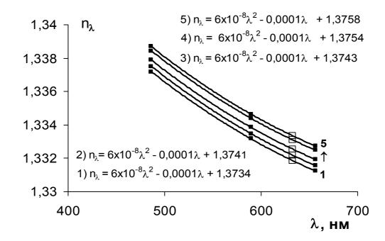
Рис. 12. Зависимости показателей преломления от длины волны падающего света для водных растворов Твин 80 различных концентраций:  $1-3.92\cdot10^{-3}$ ,  $2-6.54\cdot10^{-3}$ ,  $3-9.16\cdot10^{-3}$ ,  $4-1.31\cdot10^{-2}$ ,  $5-1,57\cdot10^{-2}$  г/см<sup>3</sup>. Бесцветные символы соответствуют значениям  $n_{632.8}$ .
