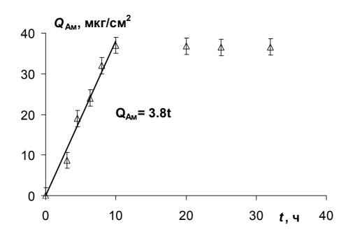
Рис. 74. Зависимость от времени количества амлодипина, высвобождающегося из полимерной матрицы на основе эмульсии  $Э_{\text{МИЦАм}}$ .
