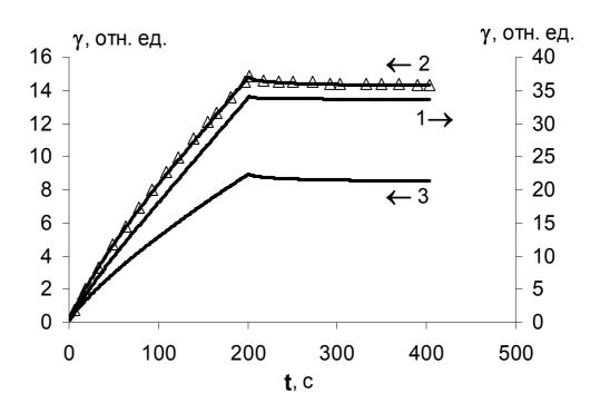
Рис. 95. Зависимости деформации от времени на стадиях ползучести и восстановления для двойных эмульсий с ДТ:  $1 - ДЭ_{ДТ}35$ ,  $2 - ДЭ_{ДТ}45$  (сплошная линия, без Лк) и  $ДЭ_{AMДT}45$  (символы, с Лк),  $3 - ДЭ_{ДТ}60$ .
