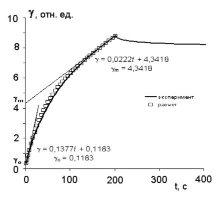
Рис. 66. Развитие деформации во времени на стадиях ползучести и восстановления для раствора  $P_{\text{ДТ}}35$ . Сплошные линии — эксперимент, символы — расчет по уравнению Бюргерса (уравнение 39).
