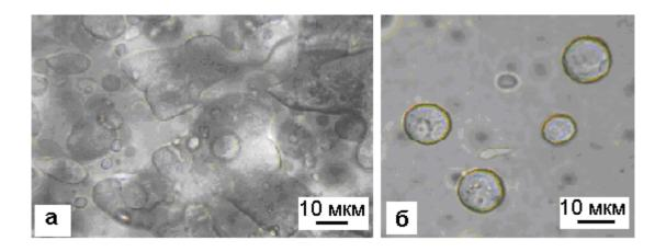
Рис. 82 (а, б). Морфология ДЭ на основе 47 масс. % раствора ПИБ в гептане с различной массовой долей миниэмульсии без Лк: 1-0.45 и 2-0.10 масс. долей.
