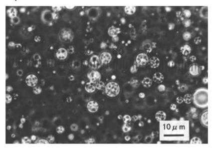
Рис. 10. Морфология двойной эмульсии  $M_1/B/M_2$ , содержащей ретинол и стабилизированной гидрофобной глиной [124].
