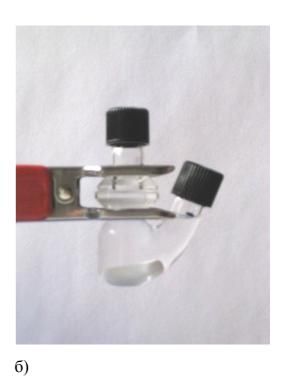
Рис. 15. Диффузионные ячейки Франца для определения скорости массопереноса целевого компонента (Лк или белка) через мембрану из жидких
