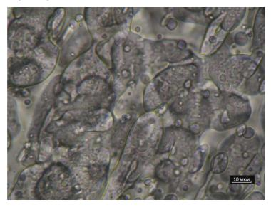
Рис. 89. Морфология пленки, сформированной на основе двойной эмульсии  $ДЭ_{\Phi\Pi U E}47$  (оптическая микроскопия).
