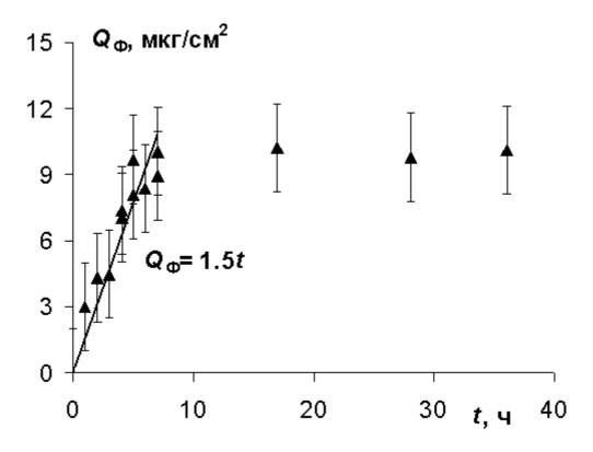
Рис. 71. Зависимость от времени количества фелодипина, выделившегося из пленки на основе обратной эмульсии Э<sub>МИПФ</sub>.
