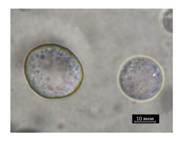
Рис. 83. Морфология ДЭ на основе 47 масс. % раствора ПИБ в гептане с 0.10 массовой долей первичной миниэмульсии без Лк (оптическая микроскопия).
