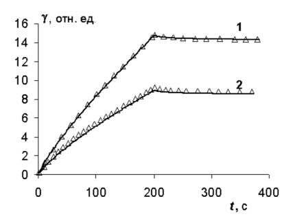
Рис. 117. Зависимости деформации от времени (режим ползучесть – восстановление) для двойных эмульсий с лизоцимом и без:  $1 - ДЭ_{Л3ДТ}45$  (символы) и  $ДЭ_{ДТ}45$  (сплошные линии),  $2 - ДЭ_{Л3ДТ}60$  (символы) и  $ДЭ_{ДТ}60$  (сплошные линии).
