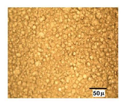
Рис. 79. Морфология эмульсии  $Э_{MЭAM}$  (оптическая микроскопия).
