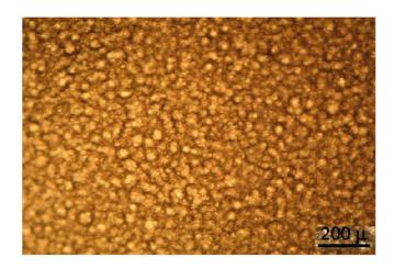
Рис. 72. Морфология эмульсии Эмицам (оптическая микроскопия).
