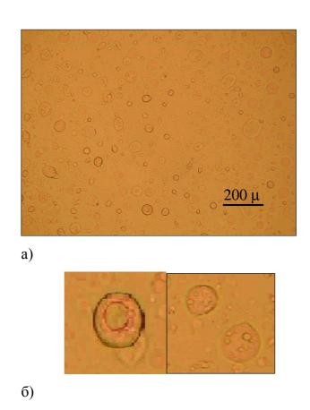
Рис. 77 (а, б). Полимерная матрица на основе эмульсии  $Э_{MЭ\Phi}$  с фелодипином (а), увеличенное изображение микродоменов (б). Данные ОМ.
