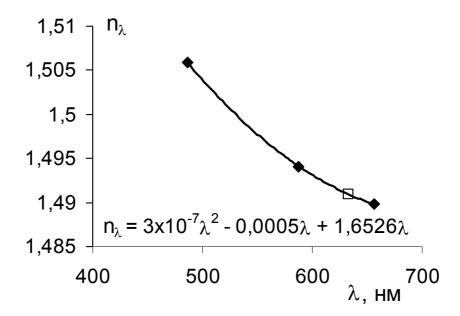
Рис. 11. Зависимость показателей преломления от длины волны падающего света для толуола. Бесцветный символ соответствует  $n_{632.8}$ .
