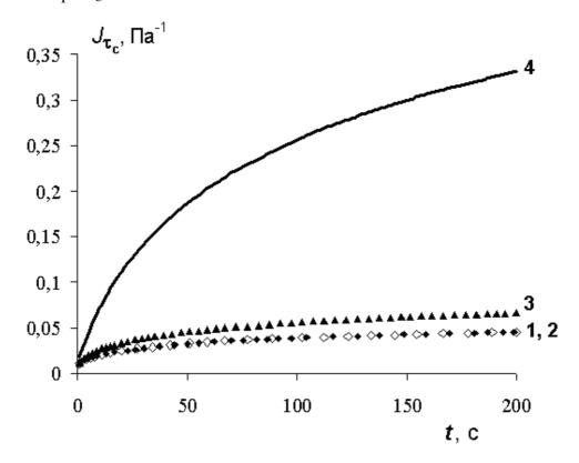
Рис. 108. Кинетика податливости для эмульсии Эм2 при различных значениях приложенного напряжения сдвига ( $\tau_C$ , режим ползучести):  $\tau_C = 0.5$  Па (1), 1 (2), 5 (3), 10 (4).
