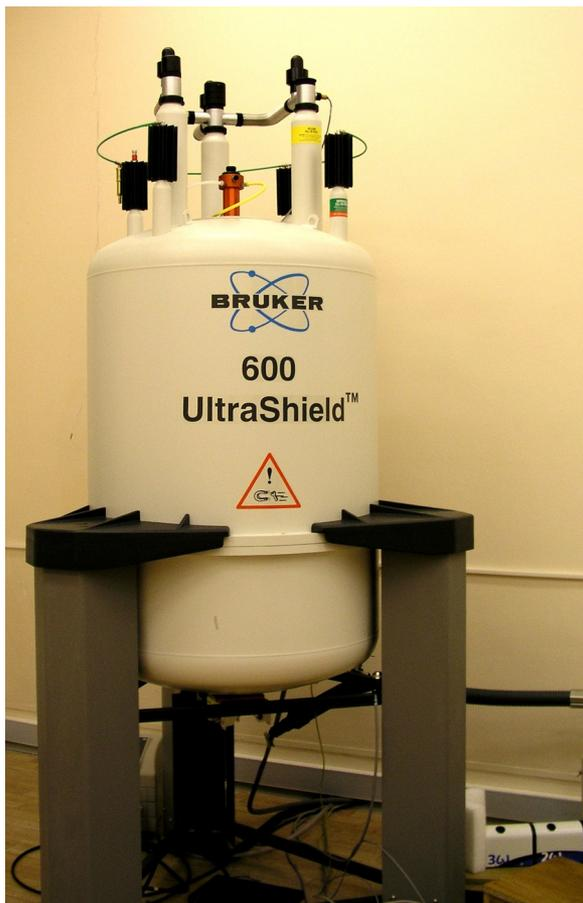
Магнит спектрометра Bruker AVANCE 600
