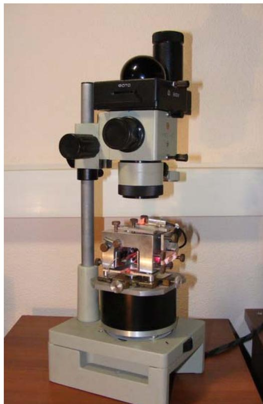
интерференции определяется разностью хода лучей  $\Delta$  по формуле:  $\Delta = N \cdot \lambda = (l_0 - l_1)n_0$ , где  $n_0$  — показатель преломления окружающей среды,  $l_0$   $l_1$  — расстояния от делительной пластинки до опорного зеркала и образца,  $N$  — порядок интерференции,  $\lambda$  — длина волны света. Имея интерференционную картину поверхности исследуемого образца, можно легко и быстро производить высокоточное позиционирование зонда и
