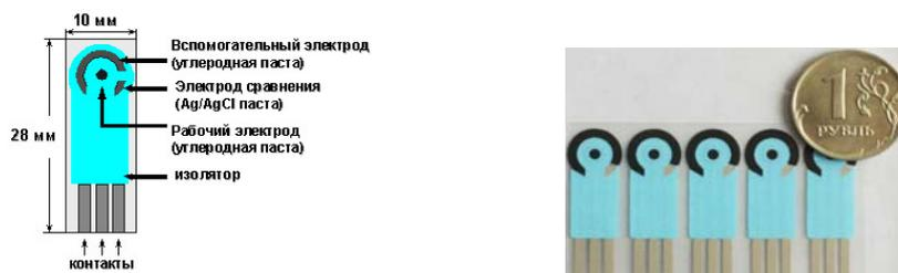
Рис. 1. Схема и фотография планарных screen-printed электродов.
